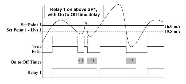
19. ON DELAY 1 (default 0.5 seconds) 22. ON DELAY 2 (default 0.5 seconds)
